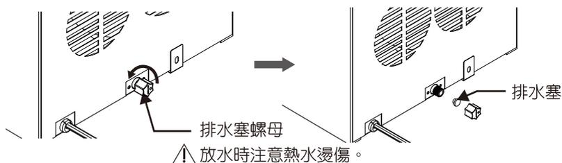
3 放水完後，塞回排水塞，裝回排水塞螺母。
