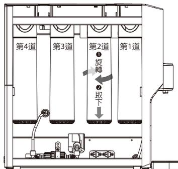
step 4：請參考右圖旋上方向將新的濾心逆時針方向向上旋上，更換完畢時濾心貼紙應為對向自己為正確方向，請確認有確實旋緊，避免造成漏水。
