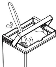
step 4：倒掉檸檬酸水，再用清水沖洗，洗掉殘留檸檬酸，並將水倒掉，即可完成水箱清洗。
