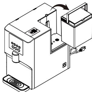
step 2：請將取下的水箱加入自來水到-MAX-標示位置，並加入食用級檸檬酸水。
